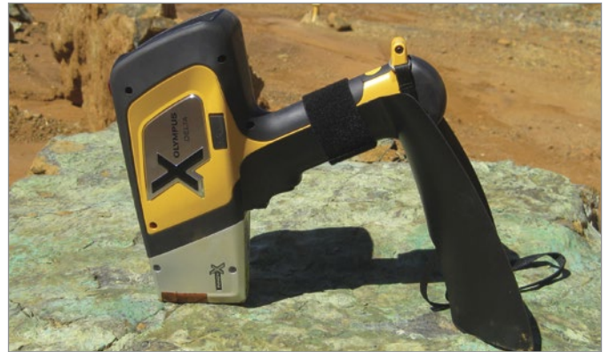
DELTA installé sur un support au sol
