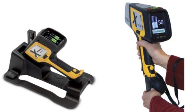
DELTA分析仪插接站的独特之处在于使用插接站时无需关闭分析仪。插接站为分析仪中的电池和备用电池充电，并定期进行校准核查。DELTA分析仪利用热插拔电池更换技术，可以在现场进行7天24小时不停歇检测操作。
