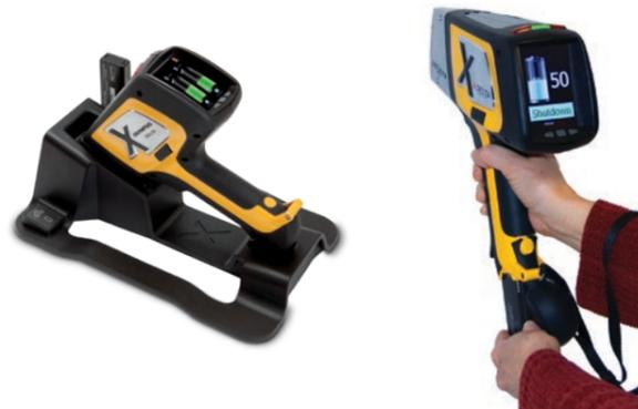
В комплект поставки РФ-анализатора DELTA входит уникальная станция подзарядки. Теперь оператору не требуется выключать прибор для замены аккумулятора. Док-станция производит подзарядку основного (в приборе) и дополнительного аккумулятора и осуществляет периодическую калибровку анализатора. Анализатор DELTA способен работать круглосуточно (24/7) в полевых условиях, благодаря возможности замены батареи в «горячем режиме»\*.
