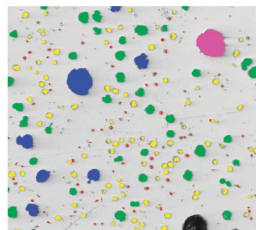
鋳鉄解析 (延性鋳鉄における球状化黒鉛)
