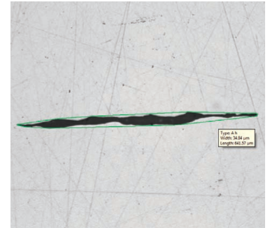
非金属介在物解析(最悪視野) (非金属介在物含有の鉄鋼)
