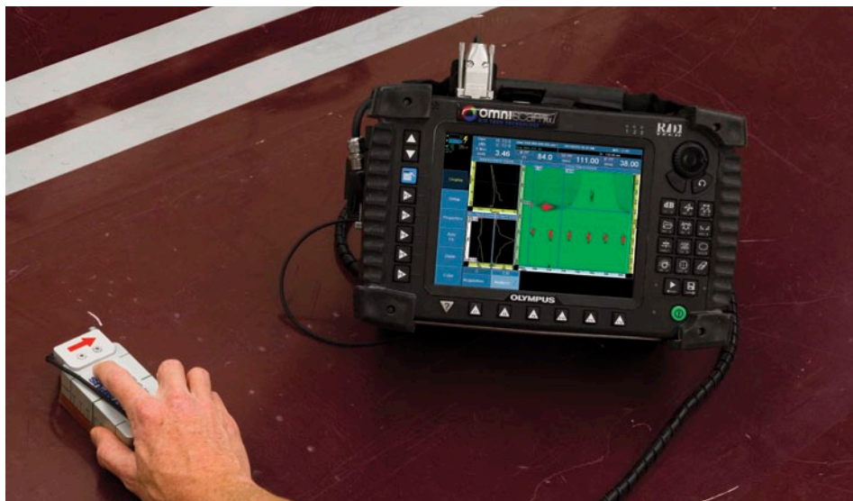
Écran affichant le C-scan, le plan d'impédance et les vues de représentation temporelle. Remarquez les bords des renforts internes et les rivets clairement identifiables.
