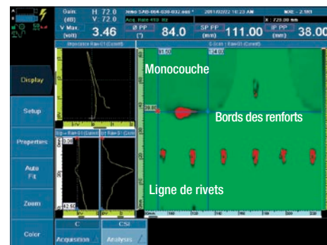
Écran affichant le C-scan, le plan d'impédance et les vues de représentation temporelle. Remarquez les bords des renforts internes et les rivets clairement identifiables.
