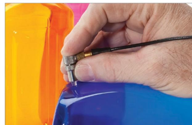
Mesure d'un matériau plastique mince à l'aide d'une sonde à ligne à retard de 20 MHz
