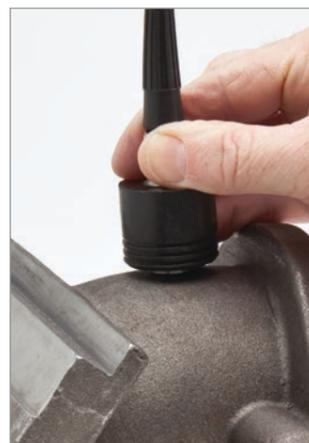
L'option logicielle haute pénétration permet de mesurer plusieurs pièces de fonte ou matériaux à forte atténuation.
