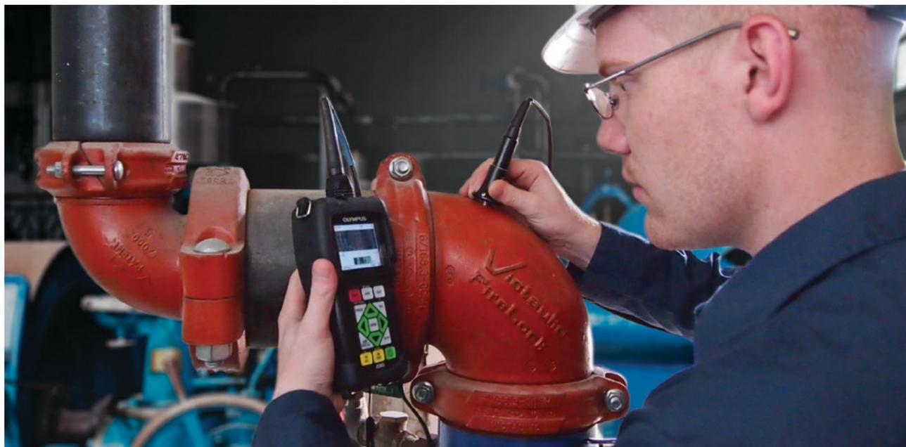
Le 45MG est un mesureur d'épaisseur à ultrasons avancé doté de fonctions de mesure et d'options logicielles standard. Cet appareil unique est compatible avec la gamme complète de sondes à émission-réception séparées et monoéléments d'Olympus ce qui en fait une solution tout-en-un pour pratiquement toutes les applications de mesure d'épaisseur.
