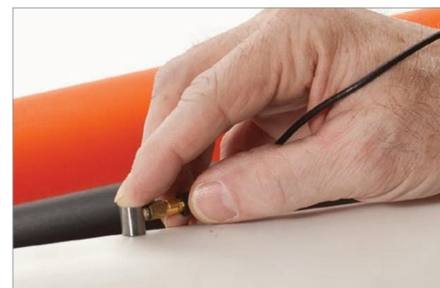
Mesure de verre mince avec la sonde Sonopen® V260-SM. Mesure d'un grand nombre de matériaux : plastique, métal, caoutchouc, verre, céramique et composites.
