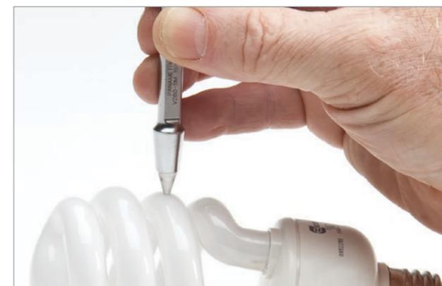
Misura di componenti in vetro sottili con un trasduttore V260-SM Sonopen®.
