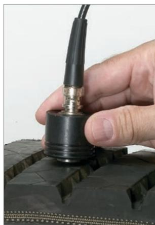
Misura della profondità allo strato o all'intreccio di fili in acciaio in nastri trasportatori o pneumatici.
