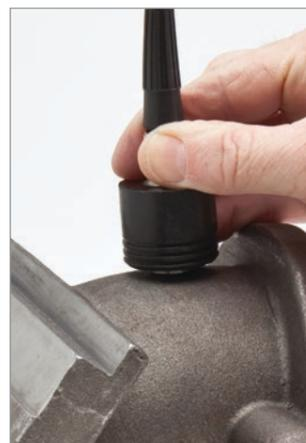
La maggior parte delle componenti in ghisa o in materiale a elevata attenuazione possono essere misurate con l'opzione software High Penetration.
