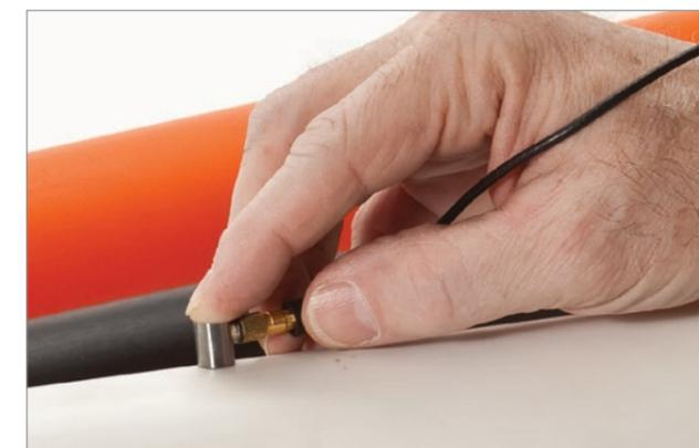
Misura di componenti in vetro sottili con un trasduttore V260-SM Sonopen®. Misura dello spessore di componenti in numerosi materiali come plastica, metallo, gomma, vetro, ceramica e materiali compositi.
