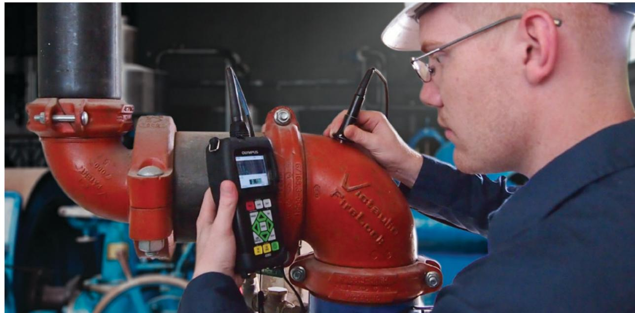
L'innovativo misuratore di spessori a ultrasuoni 45MG integra delle funzionalità di misura di serie e delle opzioni software. Questo eccezionale strumento è compatibile con la gamma completa di trasduttori per misuratore di spessori a singolo e doppio elemento, rendendolo una soluzione all-in-one per praticamente qualunque applicazione di misura di spessore.
