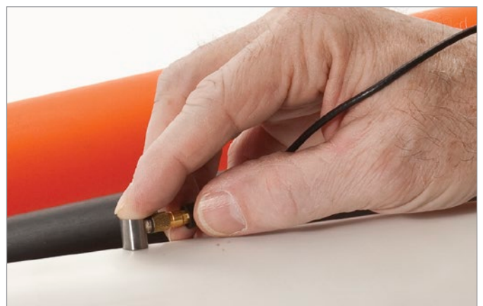
Mede a espessura do vidro com o transdutor V260-SM Sonopen®. Mede a espessura de vários materiais como plástico, metal, borracha, vidro, cerâmica e compósitos.
