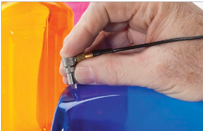
Mede a espessura do material plástico usando um transdutor de linha de atraso de 20 MHz.
