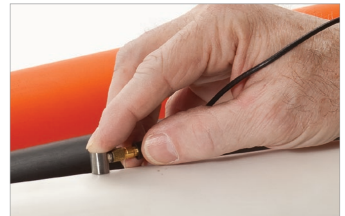
可测量包括塑料、金属、橡胶、玻璃、陶瓷及复合材料在内的很多材料的厚度
