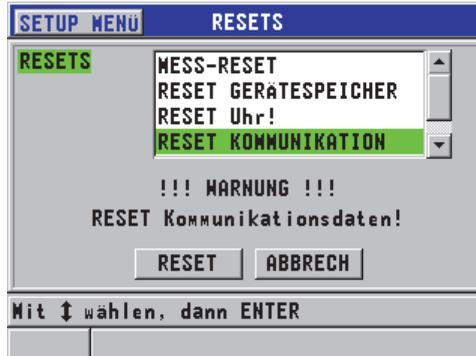
Abbildung 11-6 Fenster RESET mit Auswahl von RESET KOMMUNIKATION
