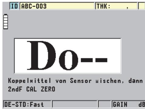
Abbildung 5-2 Fenster mit normalem D79X-Sender-Empfänger-Messkopf
