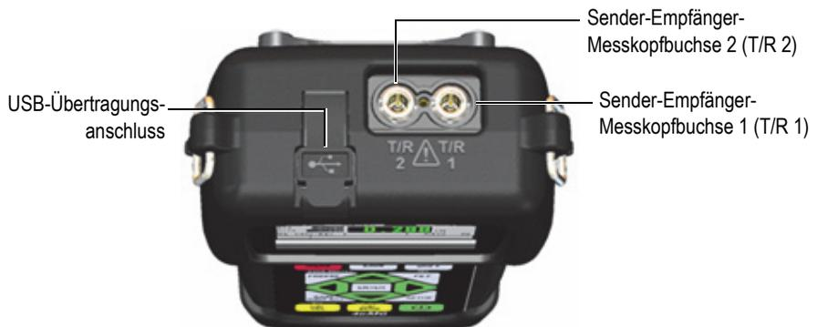
**Abbildung 1-3 Anschlüsse auf der Oberseite**
