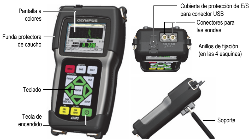
Figura 1-1 Componentes hardware del 45MG: parte frontal, superior y lateral
