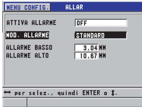
Figura 7-7 Regolazione dell'allarme STANDARD
