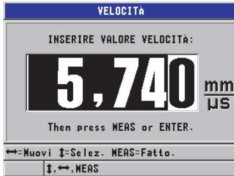
**Figura 5-9 Inserimento della nota velocità di propagazione dell'onda sonora nel materiale**
