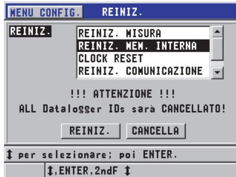
Figura 6-33 Messaggio di avvertimento visualizzato durante la reinizializzazione delle misure
