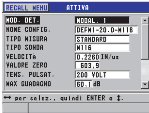
**Figura 10-1** La schermata **ATTIVA** per la configurazione di un trasduttore a singolo elemento
