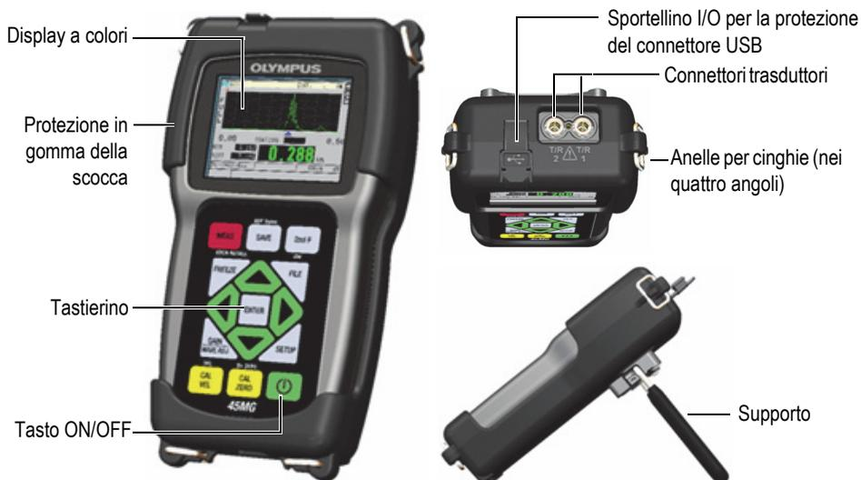
Figura 1-1 Le componenti hardware del 45MG – Viste frontale, superiore e laterale
