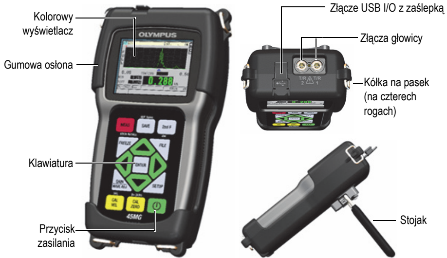
Rysunek 1-1 Elementy składowe przyrządu 45MG – widok z przodu, z góry i z boku
