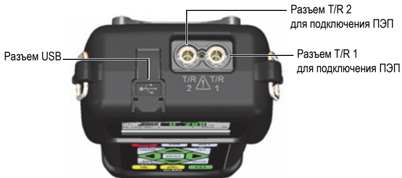
Рис. 1-3 Разъемы в верхней части прибора
