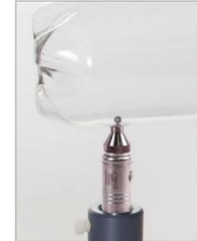
Pour des applications comme la mesure de contenants en plastique, il suffit d'insérer la petite bille cible à l'intérieur du contenant. La sonde magnétique placée à l'extérieur du contenant attire la bille. Lorsque l'utilisateur déplace la sonde sur la surface du contenant ou sur les coins difficiles d'accès, la petite bille en acier suit la sonde. En mode minimum, le mesureur affiche constamment l'épaisseur réelle et l'épaisseur la plus faible enregistrée.
