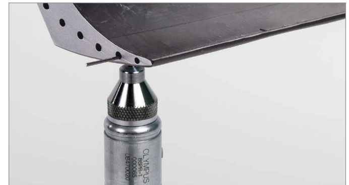
ワイヤーターゲットによるタービンブレードの肉厚測定
