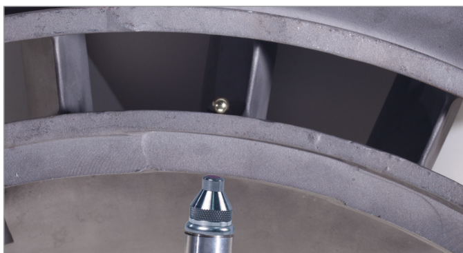
Pomiar odlewu aluminiowego z lotnictwa o grubości 24,1 mm
