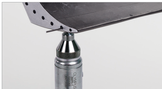
Pomiar łopatki turbiny używając targetu typu przewód
