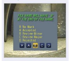
InHelp kann Bilder in Ordner ablegen, die bestimmten Abschnitten der Inspektion zugeordnet sind. Die Navigation von einem zum anderen Inspektionsbereich erfolgt mittels einem Tastendruck. Dies bietet einen schnellen und effektiven Weg für die Verwaltung von Bildern und der Verbesserung des Arbeitsablaufs. Um die Effizienz noch weiter zu steigern, ermöglicht ein Eingabefeld das Hinzufügen von Kommentaren und Schadensdiagnosen für jedes Bild.
