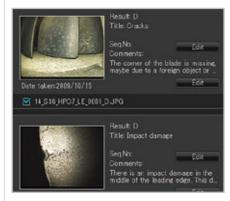
InHelp 可針對檢查的區域和 PC上 的診斷定義來判斷所記錄的圖像情 況。InHelp 還可讓用戶立即檢閱圖 像和診斷資訊。另外,亦可使用所 記錄圖像的注解、註釋和立體測量 數據資料。
