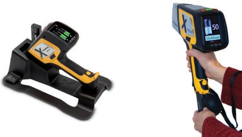
В комплект поставки РФ-анализатора DELTA входит уникальная станция подзарядки. Теперь оператору не требуется выключать прибор для замены аккумулятора. Док-станция производит подзарядку основного (в приборе) и дополнительного аккумулятора и осуществляет периодическую калибровку анализатора. Анализатор DELTA способен работать круглосуточно (24/7) в полевых условиях, благодаря возможности замены батареи в «горячем режиме».
