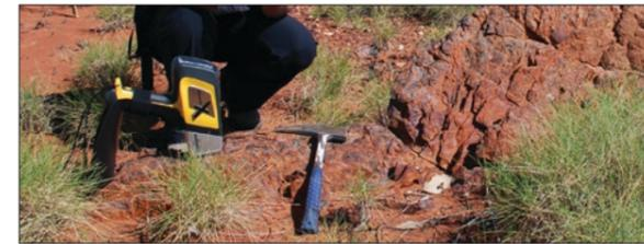
Die DELTA Ergebnisse der Elementanalyse von Metallen und leichten Elementen können für sofortige geochemische Untersuchungen über RFA-GPS-GIS problemlos übertragen werden. Dadurch können Ziele sofort kartiert, visualisiert, bewertet und nachverfolgt werden, was Entscheidungen bei der Erkundung im Bergbau unterstützt.
