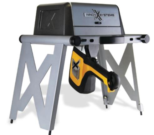
Der abgeschirmte DELTA Teststand mit integrierter Sicherheitsverriegelung kann über einen PC gesteuert werden.
