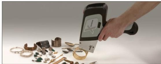
Der DELTA Analysator kann automatisch viele verschiedene Legierungen erkennen und bestimmen, wie die Edelmetalle Au, Ag, Pt und Pd. Er kann für die sofortige Bestimmung des Feingoldgehalts von 0 bis 24 Karat programmiert werden.
