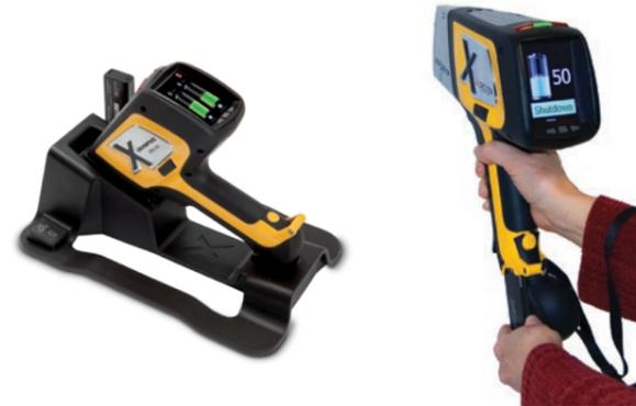
Estação de acoplamento DELTA exclusiva que elimina a necessidade de desligar o analisador. A estação carrega a bateria do analisador e a sobressalente, e realiza verificações periódicas de calibração. Os analisadores DELTA podem ser operados sem interrupção durante 24 horas por dia 7 dias por semana devido ao modo de substituição de baterias hot swap\*.
