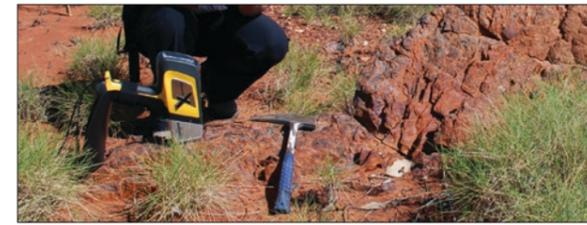
Com o analisador DELTA, os resultados de composição química de metais e elementos leves podem ser transferidos por meio de uma conexão sem fio para análises "geoquímicas instantâneas" por XRF, GPS e GIS. Ele é capaz de localizar, visualizar, investigar e produzir uma parte dos elementos examinados; auxilia na tomada de decisões durante a exploração de minérios.
