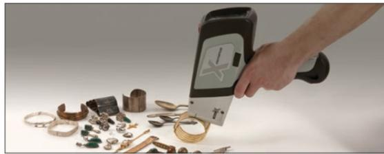
O analisador DELTA pode identificar e caracterizar automaticamente uma vasta gama de ligas, incluindo metais preciosos: ouro (Au), prata (Ag), platina (Pt) e paládio (Pd). Ele pode ser pré-programado para indicar a classificação em quilates (de 0 a 24) instantaneamente.
