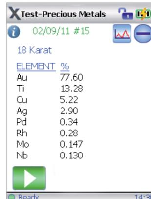
Автоматическое определение каратов
