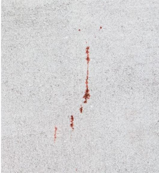
Indicación de defectos usando líquidos penetrantes (colorante rojo)
