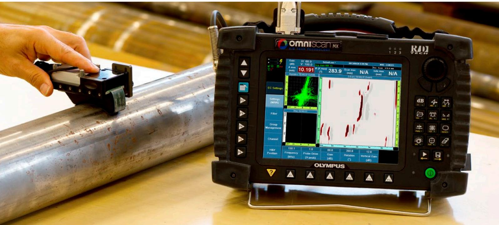
Notre ensemble novateur adapté à l'inspection des fissures par corrosion sous contrainte tire profit des courants de Foucault multiéléments (ECA) qui offrent de nombreux avantages en comparaison de l'inspection par ressuage ou magnétoscopique.
