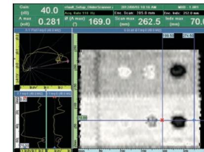
Rastreamento de alta frequência C-scan da fase, paleta de cor diferente
