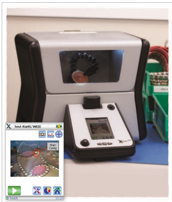
微点准直器功能用于检测极微小的样品或者用于检测样品上的微小区域。
