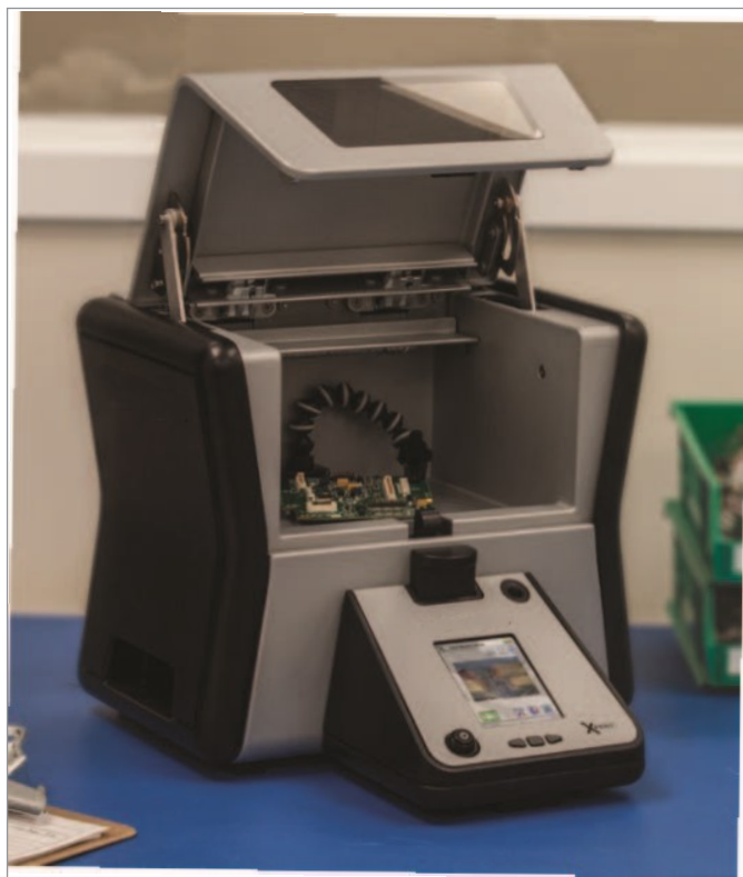
将较小的样品放在样品固定夹上，并调好方向放于分析窗口上。
