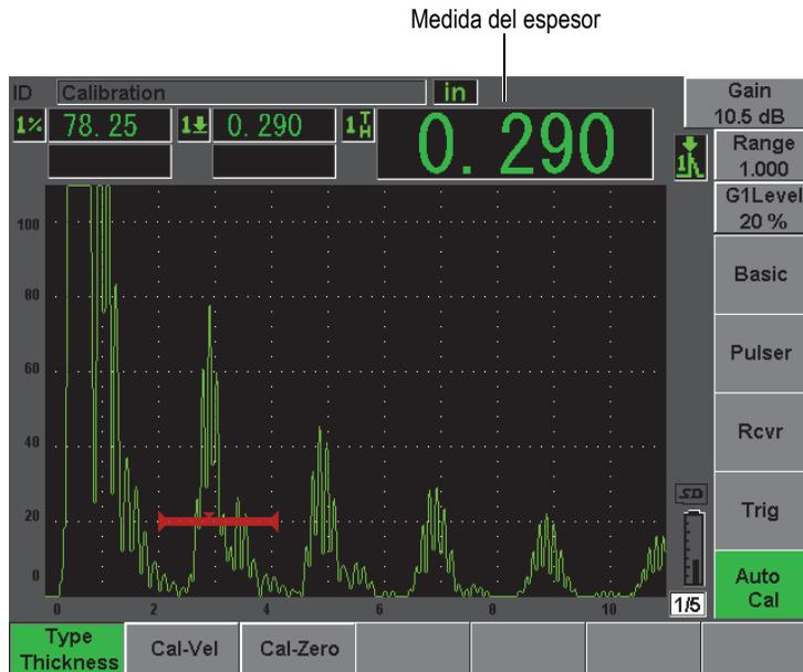
Figura 10-1 Ejemplo de una señal en la puerta para la calibración del cero
