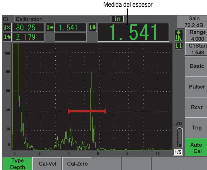
**Figura 10-26** Ejemplo de una señal en la puerta para la calibración del cero
