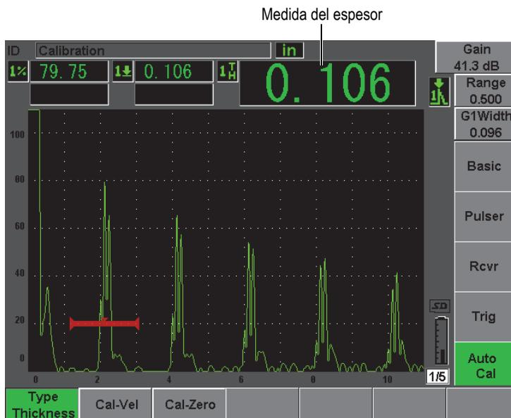
Figura 10-6 Ejemplo de una señal en la puerta para la calibración del cero
