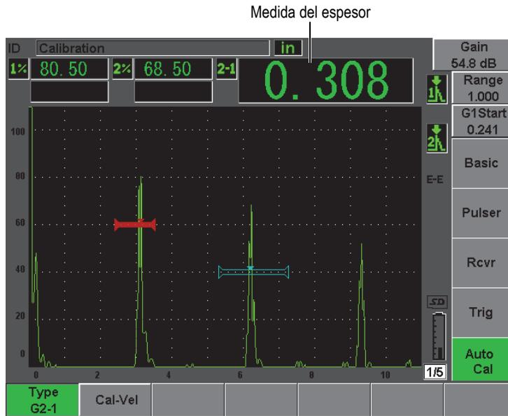
**Figura 10-14** Ejemplo de una señal en la puerta para la calibración de la velocidad de propagación
