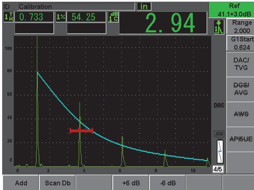
**Figura 12-9** Curva DAC de tipo ASME con una ganancia de inspección añadida de 3 dB
