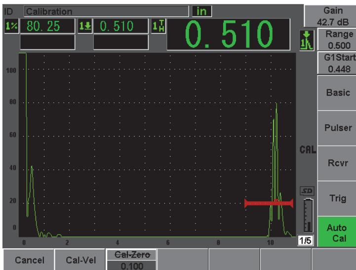
**Figura 10-8 Ejemplo de una señal en la puerta para la calibración de la velocidad de propagación**
