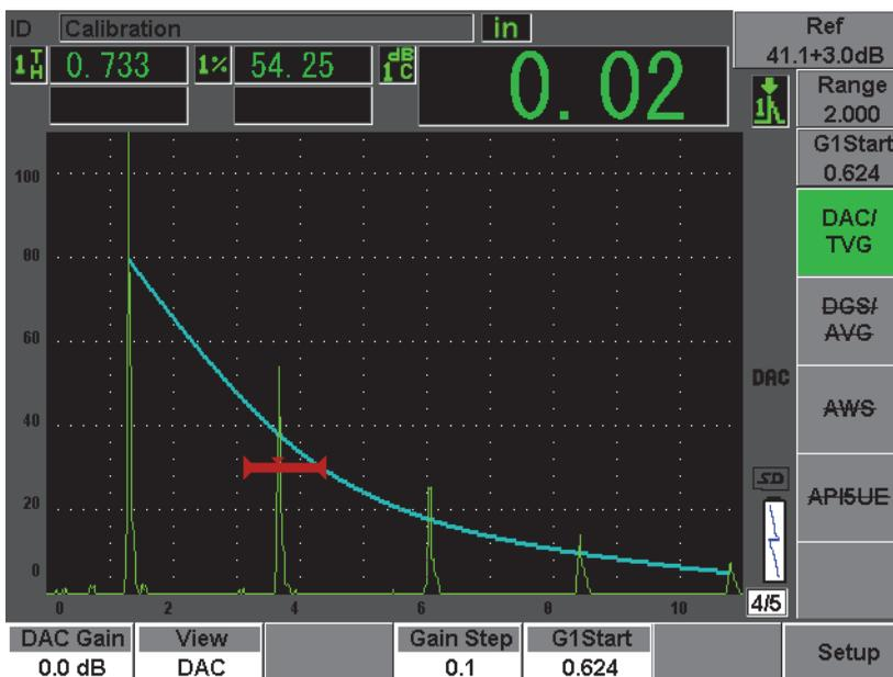
Figura 12-10 Curva DAC de tipo ASME con la ganancia de inspección añadida de 3 dB y la corrección de referencia activada
