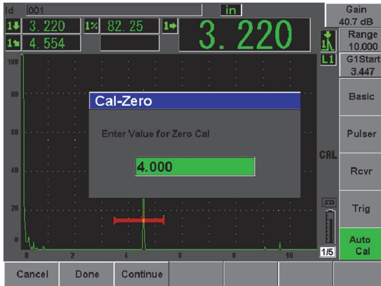
**Figura 10-21 Valor del espesor para la calibración del cero**
