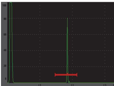
**Leg :** Cuadrícula de saltos. Muestra líneas verticales que representan los saltos en una inspección con palpadores angulares. Esta cuadrícula cuenta con hasta cuatro divisiones, enumeradas de **L1** a **L4**, que representan la distancia entre cada salto sobre la pieza bajo ensayo durante la inspección angular. El espaciado y la cantidad de divisiones depende de los parámetros seleccionados en **Basic > Range**, **Basic > Delay**, y **Trig > Thick** (espesor de la pieza bajo ensayo).
