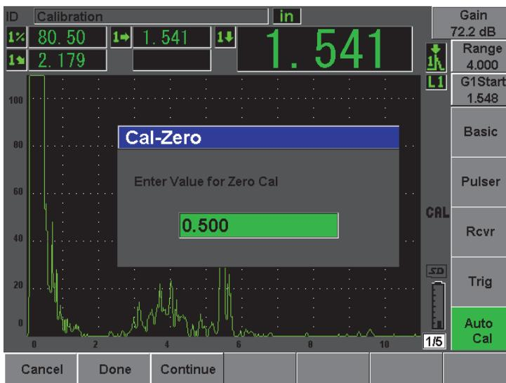
Figura 10-27 Valor del espesor para la calibración del cero
