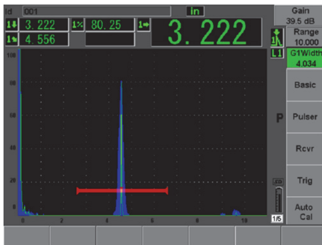
Rysunek 10-17 Zastosowanie wartości szczytowej pamięci do lokalizacji BIP
