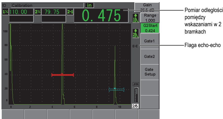
Rysunek 8-6 Przykład pomiaru echo-echo
