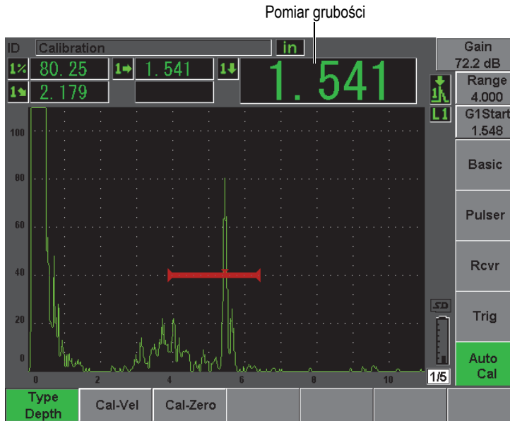
Rysunek 10-26 Przykład sygnału w bramce dla kalibracji zera
