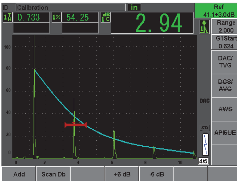
Rysunek 12-9 ASME DAC przy dodanych 3dB wzmacnienia skanowania
