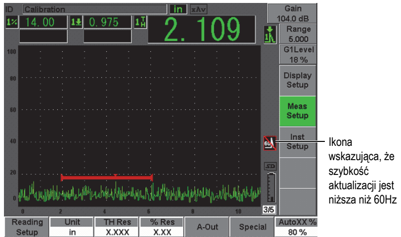
Rysunek 12-30 Szybkość aktualizacji niższa niż 60Hz
