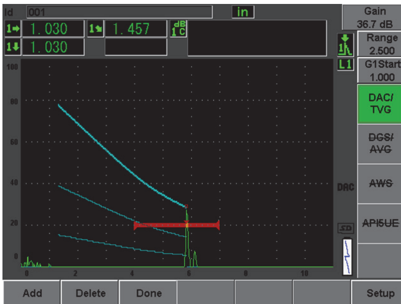
Rysunek 12-4 Ustawienia DAC, jeden punkt
