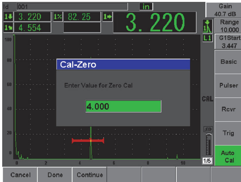
Rysunek 10-21 Wprowadzanie wartości grubości dla kalibracji zera
