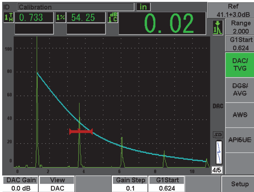
Rysunek 12-10 ASME DAC wraz ze wzmocnieniem skanowania oraz aktywną korektą odniesienie
