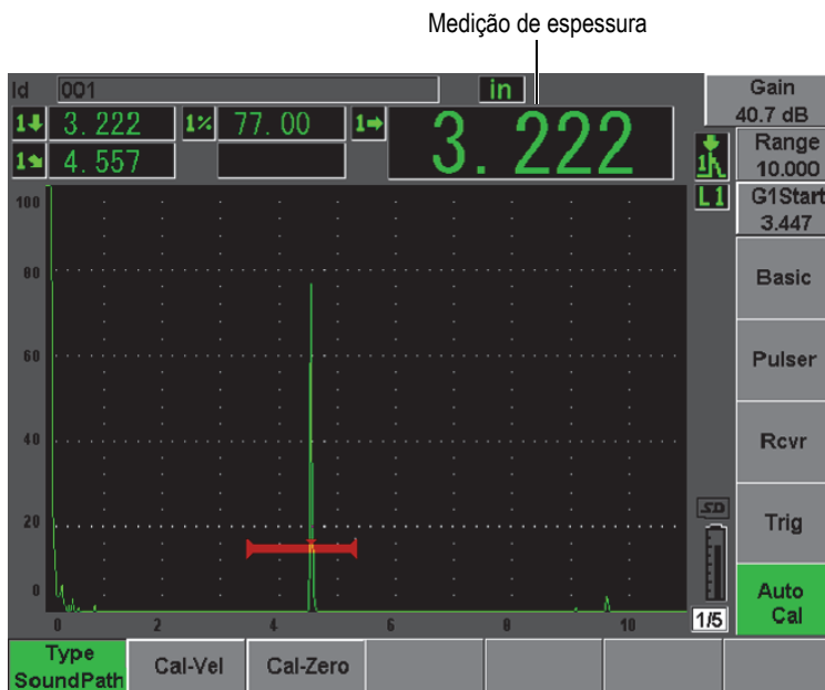
Figura 10-20 Exemplo de um sinal fechado para calibração de zero
