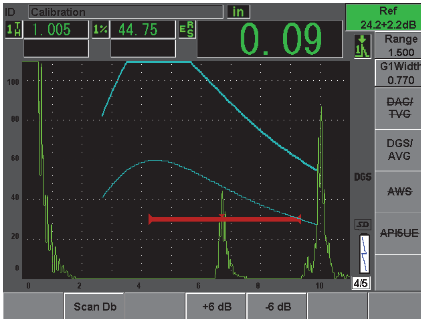
Figura 12-17 Curva do ganho DGS ajustada
