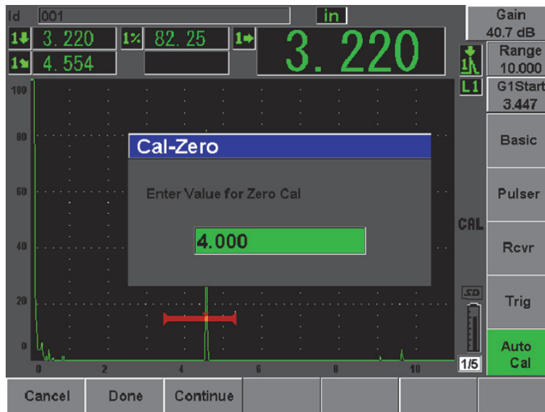
Figura 10-21 Inserindo o valor da espessura da calibração de zero
