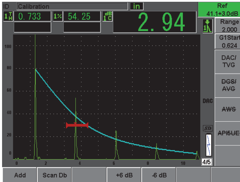
Figura 12-9 ASME DAC com 3 dB de ganho de rastreamento
