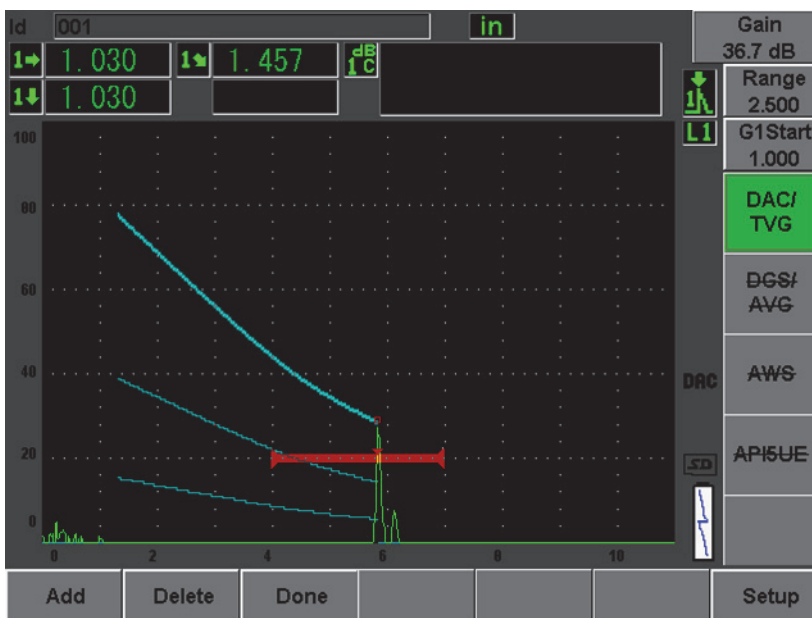
Figura 12-4 Configuração de um ponto DAC
