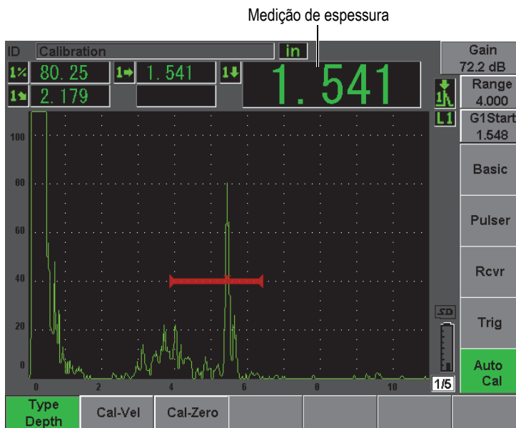
Figura 10-26 Exemplo de um sinal fechado para calibração de zero
