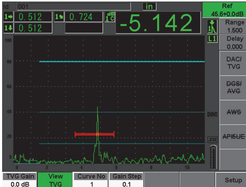
Figura 12-7 Visualização das curvas DAC no modo View DAC
