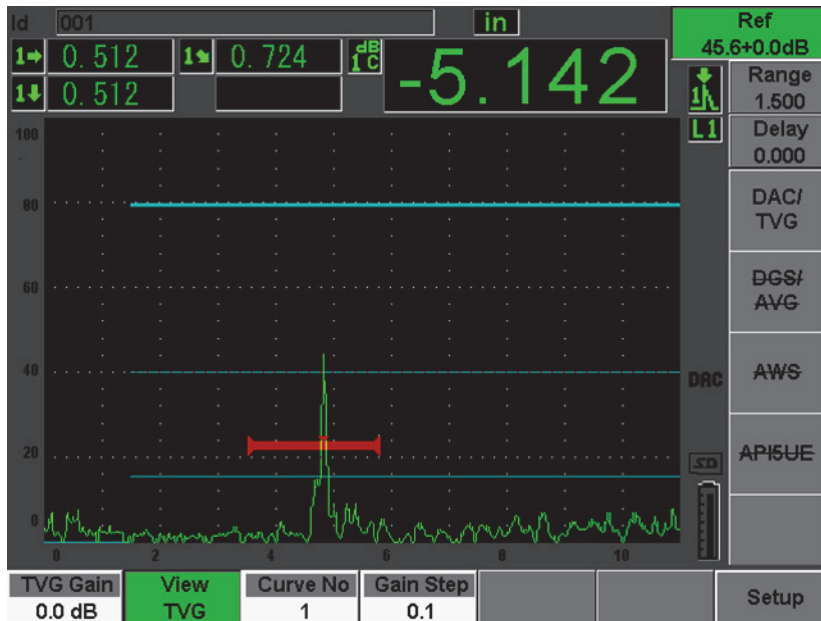
图 12-7 DAC 视图模式下已完成的 DAC 曲线
