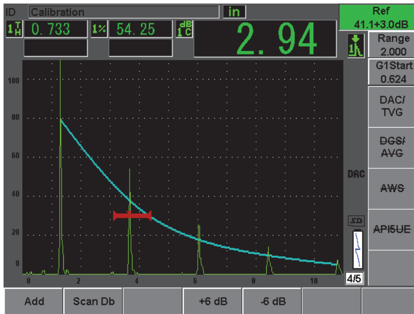
图 12-9 带有 3 dB 扫查增益的 ASME DAC
