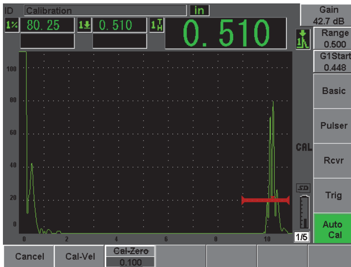
图 10-8 闸门内声速校准信号示例
