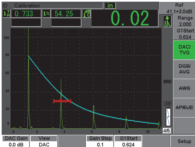
图 12-10 带有 3 dB 扫查增益和激活的参考校正的 ASME DAC
