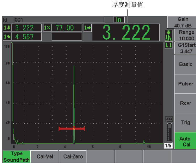
图 10-20 闸门内零位校准信号示例
