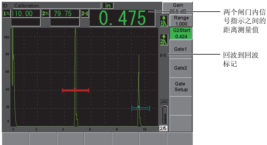
图 8-6 回波到回波测量示例
