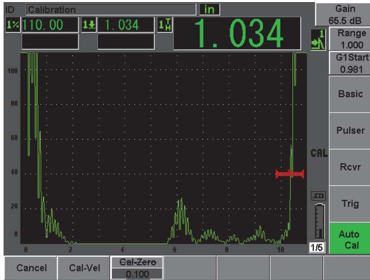
图 10-12 闸门内声速校准信号示例
