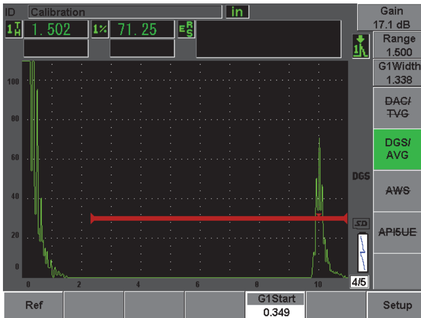
图 12-15 采集前的参考反射体
