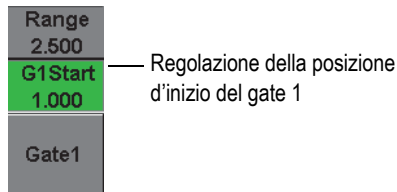
Figura 2-10 La regolazione della posizione d'inizio del gate 1
