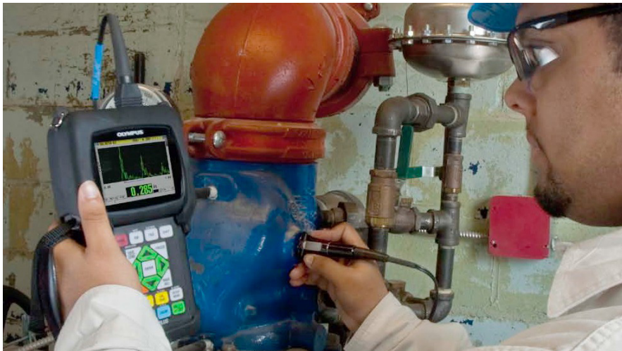
Obrázek 1-1 Měření tloušťky přístrojem 38DL PLUS
