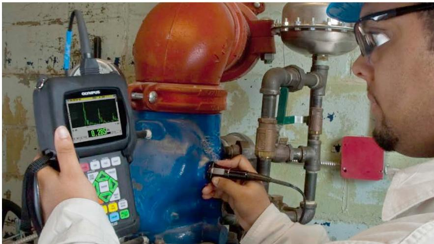
Abbildung 1-1 Messen der Dicke mit dem 38DL PLUS
