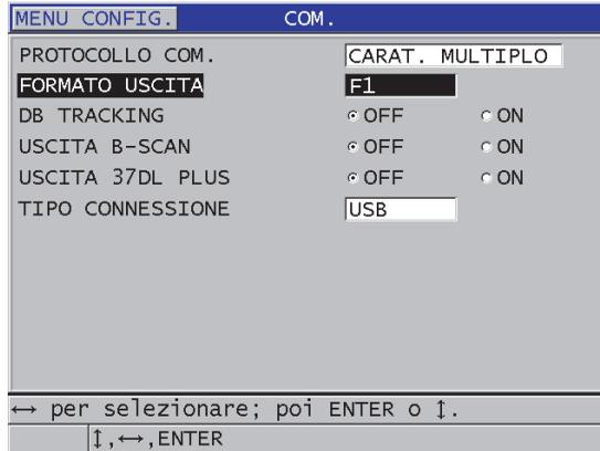
Figura 14-9 Visualizzazione o modifica del formato di trasferimento del file
