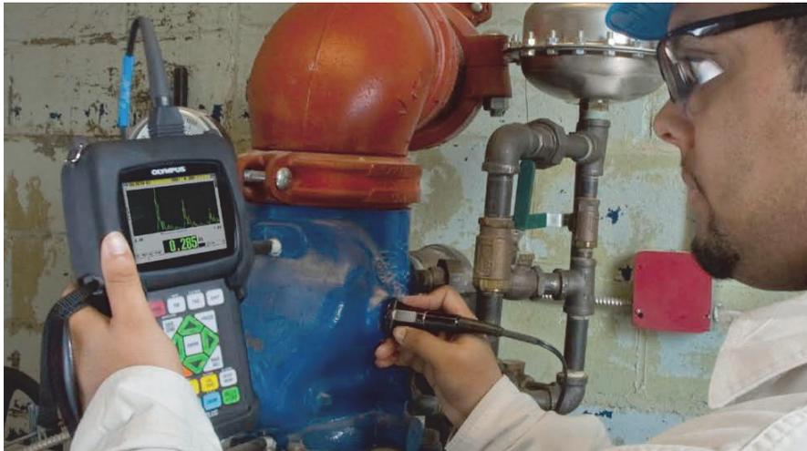
Figura 1-1 Misura di spessori con il 38DL PLUS
