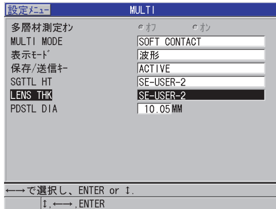
図 7-9 ソフトコンタクトモードでの多層材測定パラメータ
