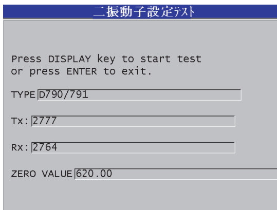
図 15-3 二振動子型探触子テスト画面
