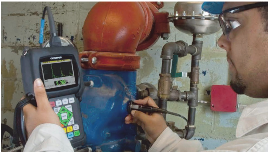
Figura 1-1 Medição de espessura com o 38DL PLUS
