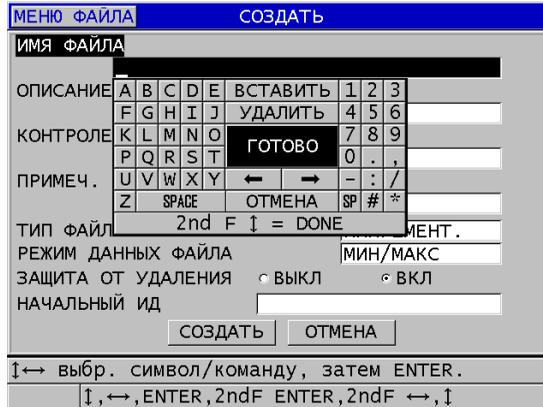
Рис. 11-4 Окно СОЗДАТЬ для инкрементного типа файла
