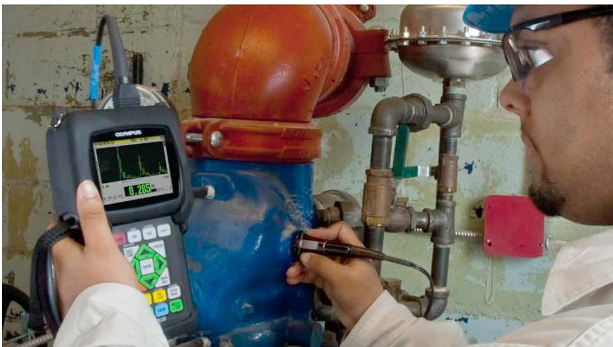
**Рис. 1-1 Измерение толщины с помощью 38DL PLUS**
