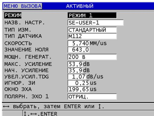
Рис. 13-1 Экран АКТИВНЫЙ для настройки одноэлементного ПЭП
