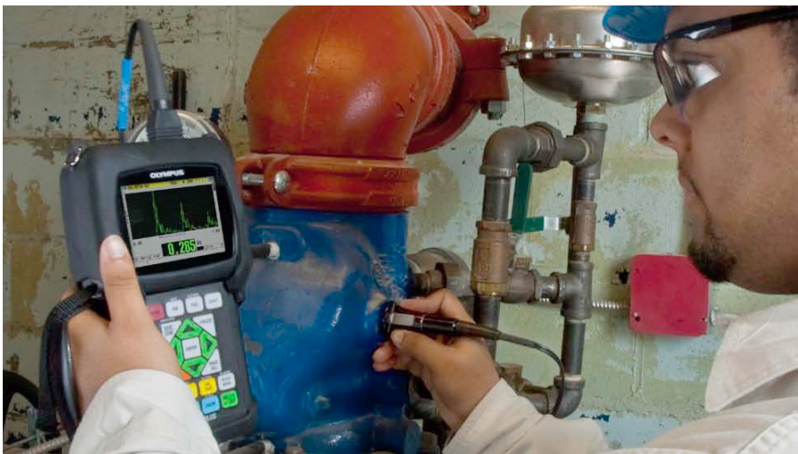
Figura 1-1 Medición de espesores con el 38DL PLUS
