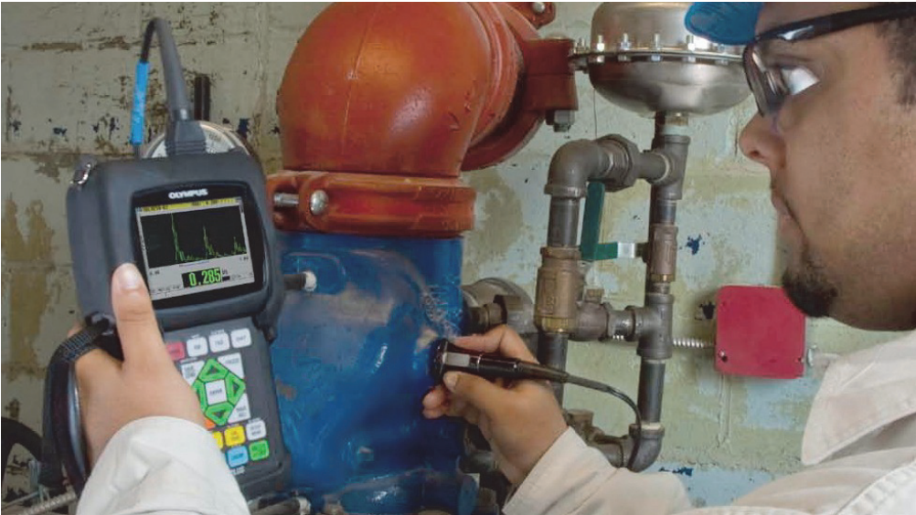
Rysunek 1-1 Pomiar grubości przy użyciu urządzenia 38DL PLUS
