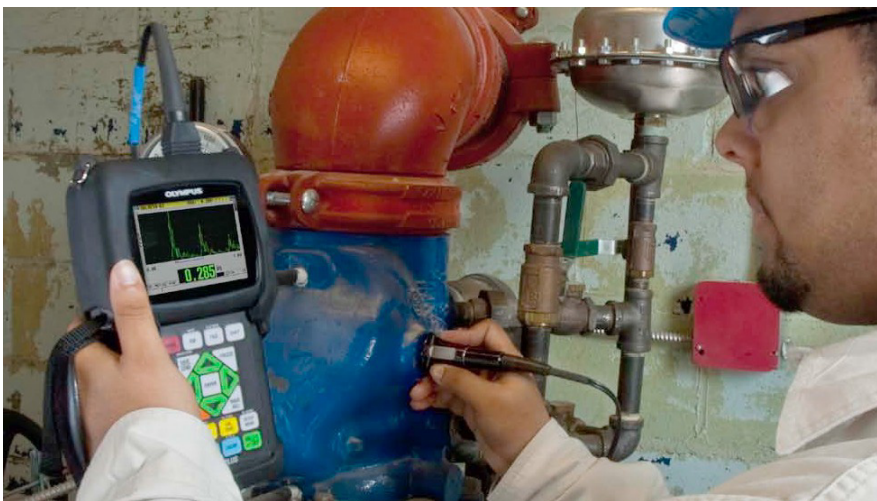
Рис. 1-1 Измерение толщины с помощью 38DL PLUS
