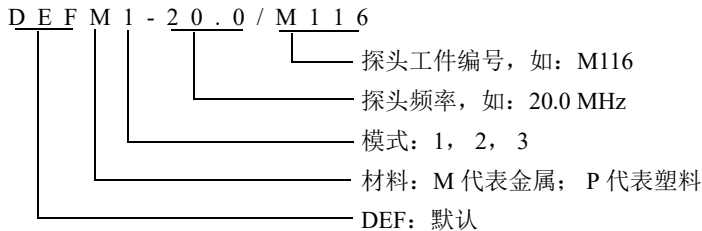
图 5-3 选择默认单晶探头的设置
