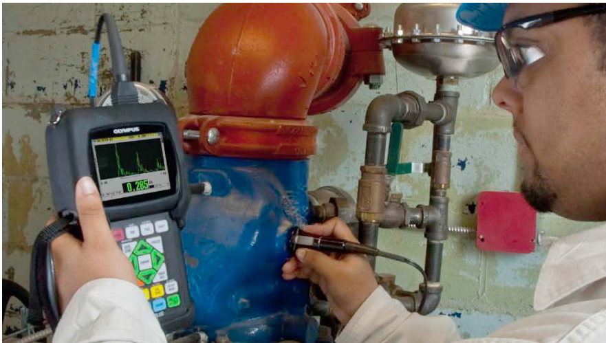
图 1-1 使用 38DL PLUS 仪器测量材料的厚度
