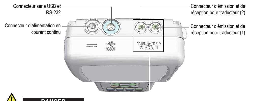
Afin d'éviter un choc électrique, ne pas toucher aux conducteurs internes des connecteurs T/R 1 et T/R 2. Le conducteur interne peut contenir jusqu'à 200 V de tension.
