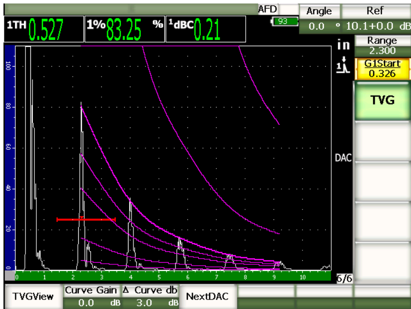
Abbildung 11-14 Fertiggestellte anwendungsspezifische DAC-Kurve
