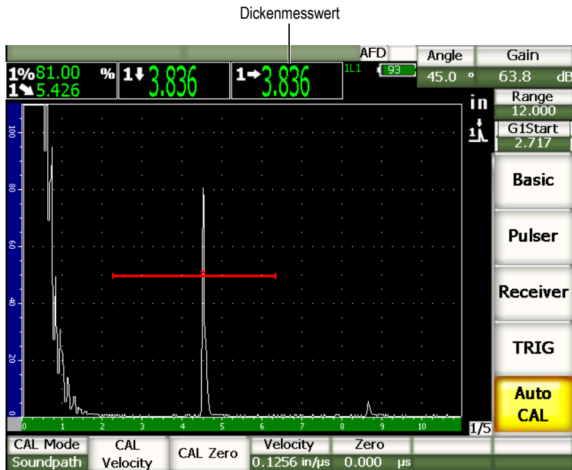
Abbildung 9-15 Beispiel eines Justiersignals in der Blende
