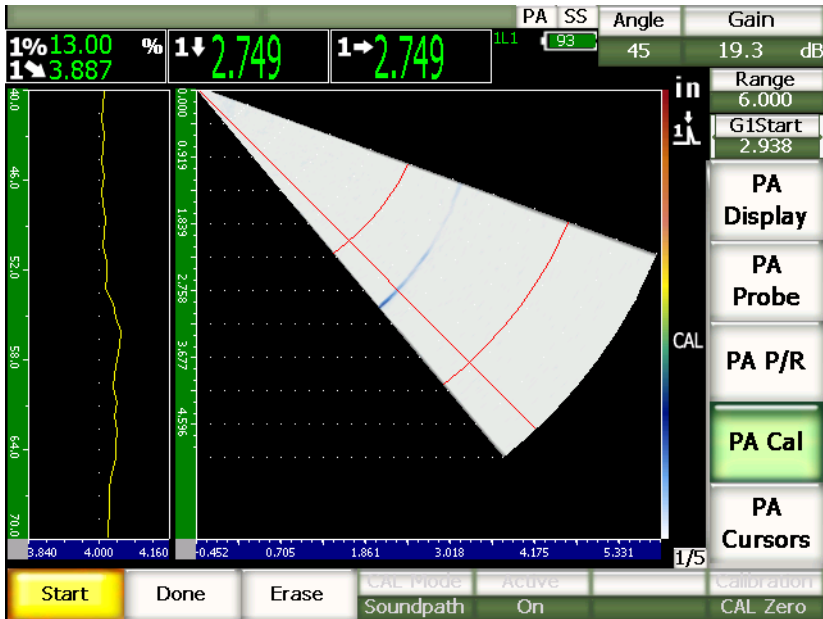
Abbildung 17-20 Bildschirm bei der Justierung des Vorlaufkeilvorlaufs
