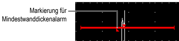
Abbildung 6-8 Markierung für Mindestwanddickenalarm
