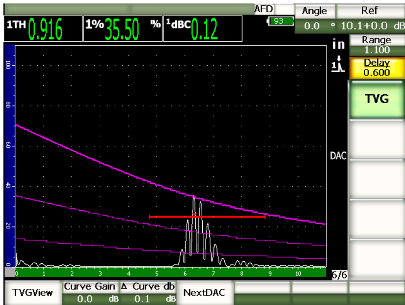
Abbildung 11-9 DAC-Kurve mit erweitertem Bereich
