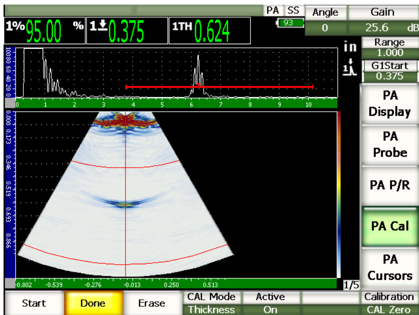
Abbildung 17-8 Fertiggestellte Justierung des Vorlaufkeilvorlaufs
