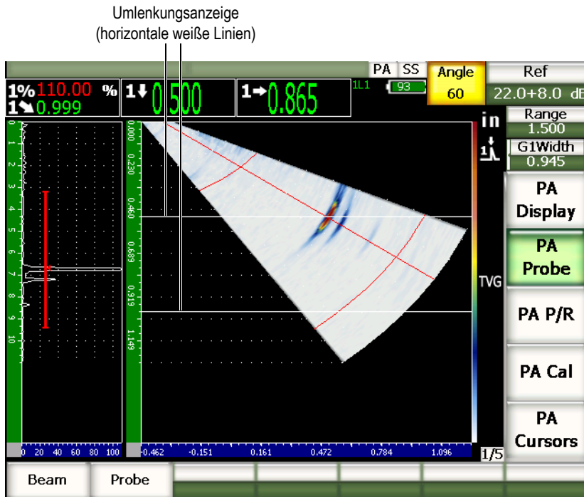
Abbildung 14-9 S-Bild mit aktivierter Anzeige der Umlenkungen
