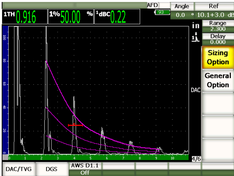
Abbildung 11-11 ASME DAC mit 3 dB Prüfverstärkung und aktivierter Referenzkorrektur
