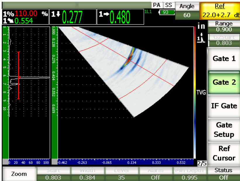
Abbildung 15-1 A-Bild und S-Bild mit Blenden
