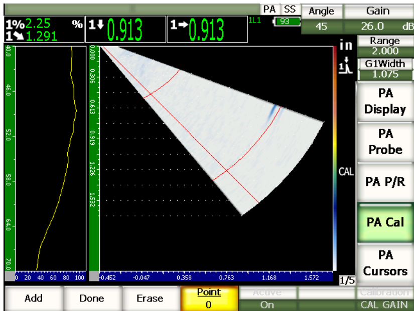
Abbildung 17-23 Bildschirm bei Erfassen der Verstärkung
