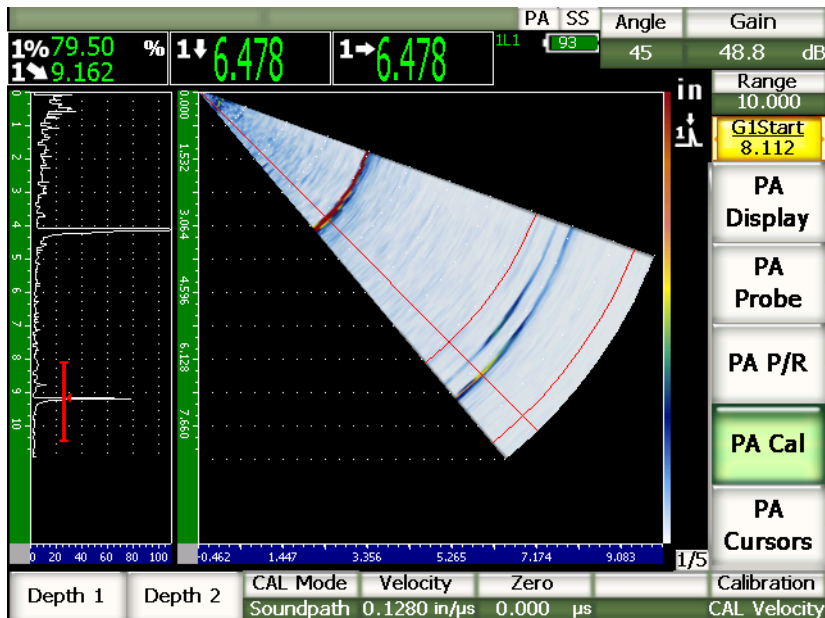
Abbildung 17-15 Das zweite Justiersignal in der Blende
