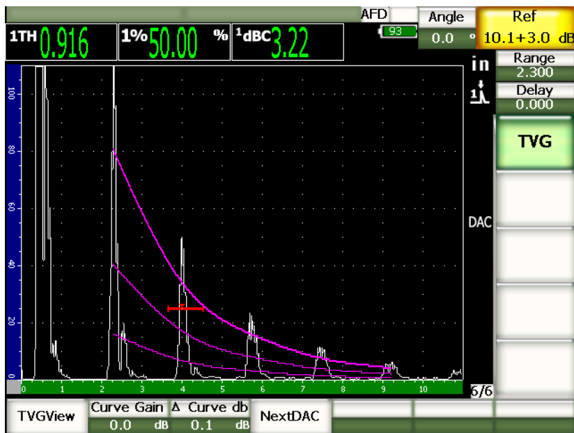
Abbildung 11-10 ASME-DAC mit 3 dB Prüfverstärkung
