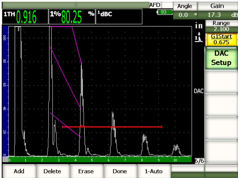
Abbildung 11-5 DAC-Einrichtung mit zwei Punkten
