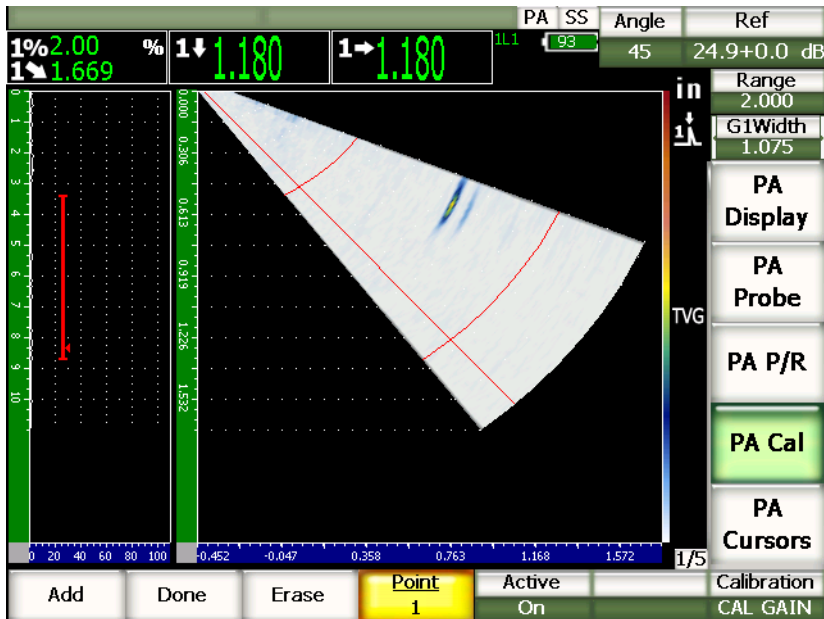
Abbildung 17-24 Fertiggestellte Justierung der Verstärkung
