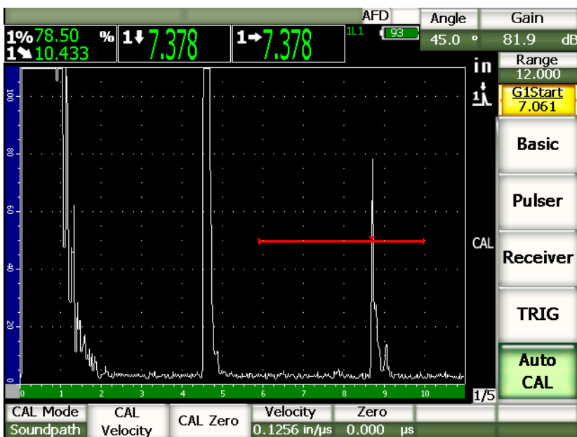
Figura 9-17 Secondo segnale di calibratura nella porta
