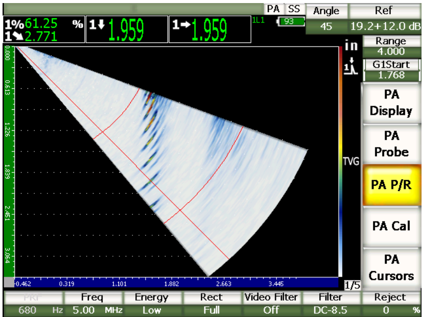
Figura 12-2 L'immagine S-scan da 40° a 70° con percorso ultrasonoro di 100 mm
