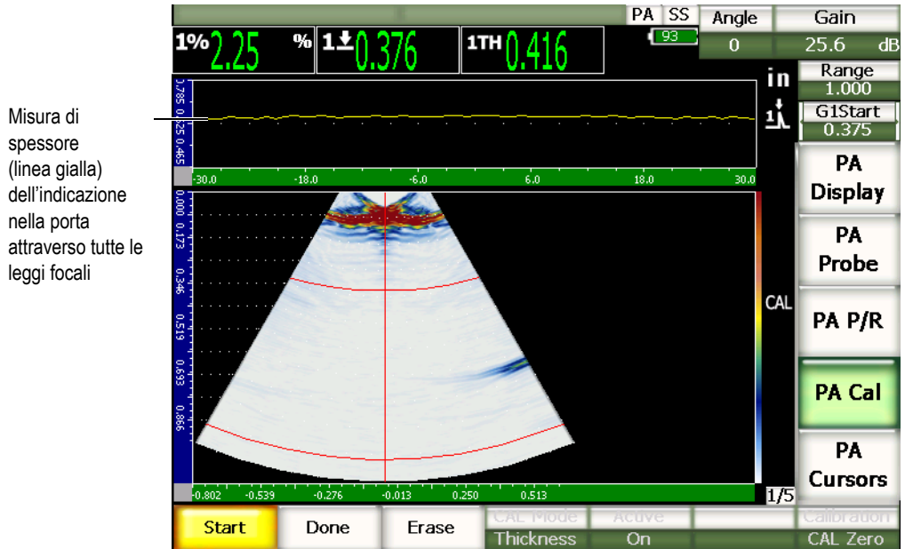
Figura 17-7 Schermata di acquisizione del ritardo dello zoccolo con lettura della misura di spessore visualizzata nella parte superiore
