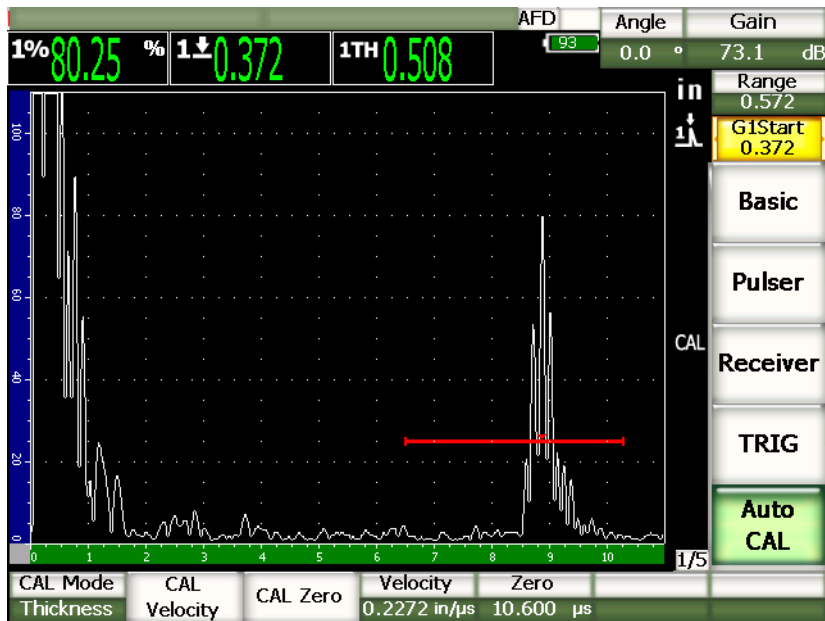
Figura 9-6 Secondo segnale di calibratura nella porta
