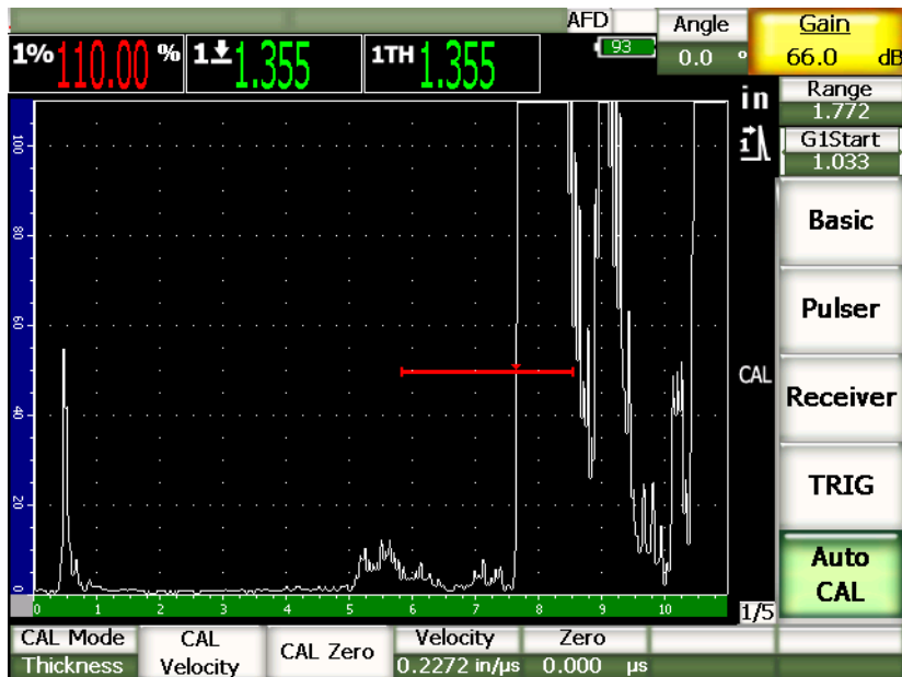
Figura 9-9 Secondo segnale di calibratura nella porta
