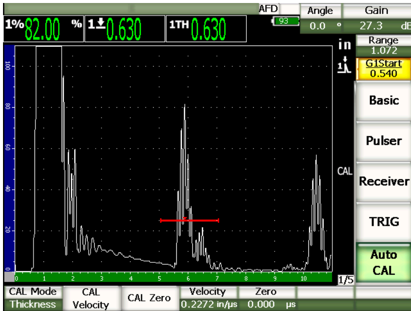
Figura 9-3 Secondo segnale di calibratura nella porta
