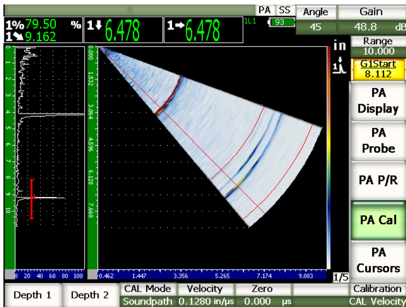
Figura 17-15 Secondo segnale di calibratura nella porta
