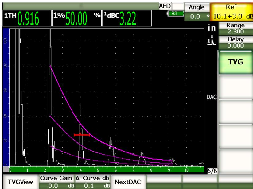
図 11-10 3 dB 補正ゲインによる ASME DAC
