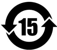
中国 RoHS マークは、環境保護使用期限 (EFUP) を示しています。EFUP マーク内の数字は、規制物質として一覧に取り上げられている物質が、漏出したり、化学的に劣化することがないとされる期間を示しています。EPOCH 1000 シリーズの EFUP は、15 年と定義されています。
