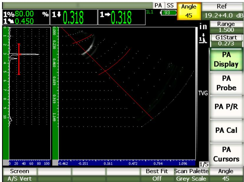
図 14-10 グレイスケールモードにて欠陥指示のある A-スキャンと S-スキャン
