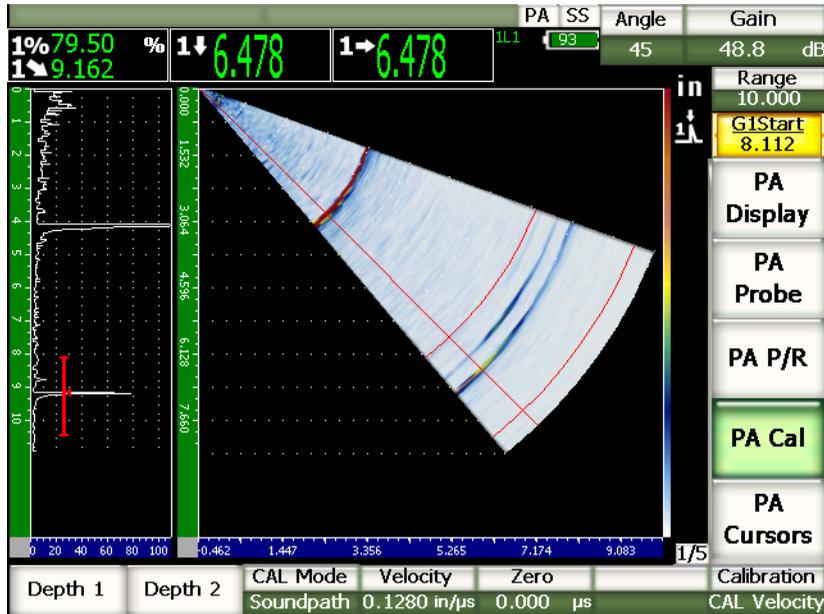
図 17-15 ゲート設定された 2 番目の校正信号
