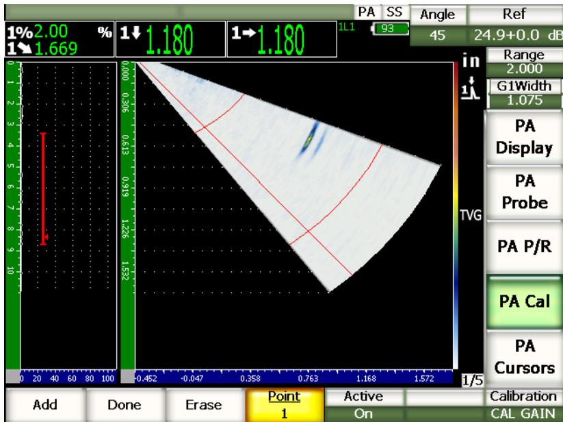
図 17-24 完了したゲイン校正
