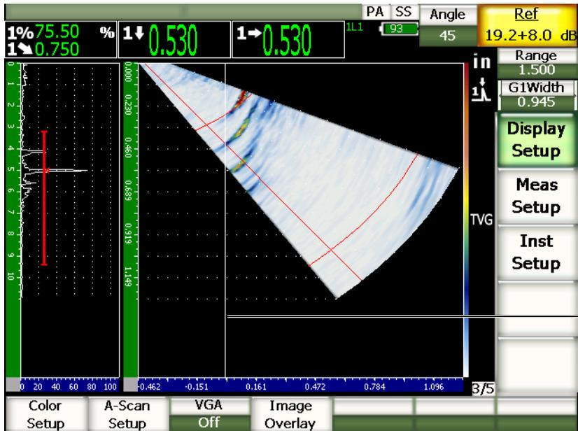
図 14-8 プローブ前面カーソルと S-スキャン
