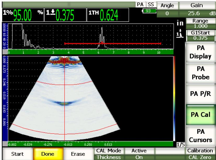
図 17-8 ウェッジ遅延校正の完了
