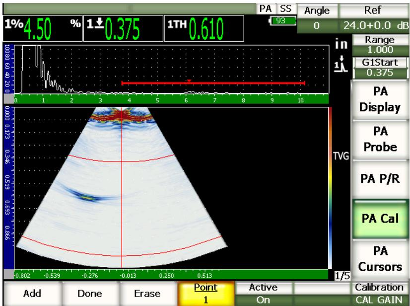
図 17-11 完了したゲイン校正
