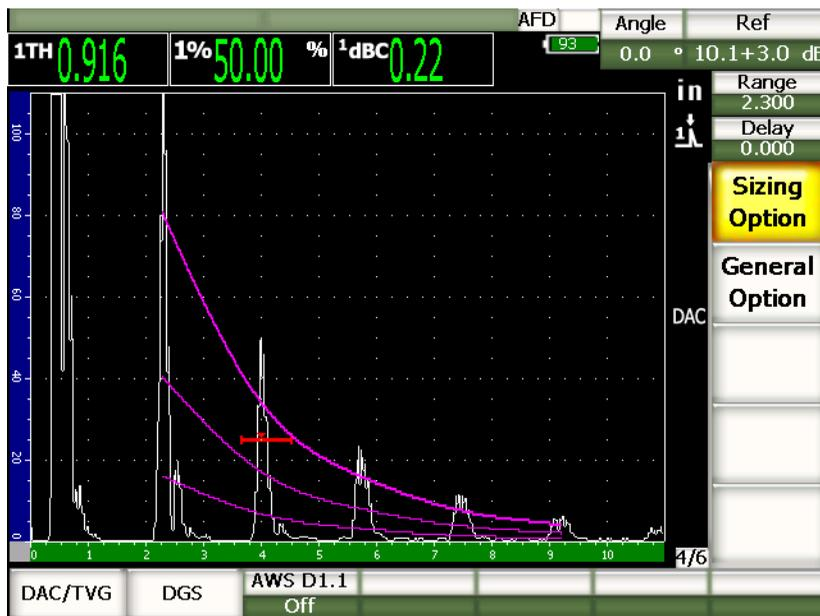
図 11-11 3 dB 補正ゲインと基準補正が有効な場合の ASME DAC
