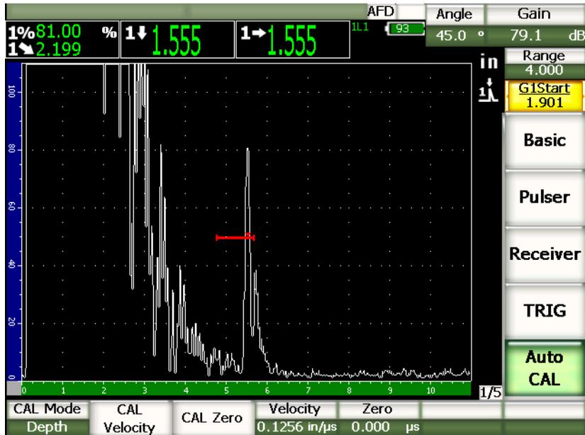
図 9-21 ゲートと校正信号の例
