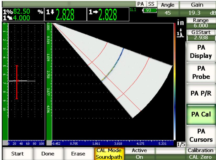
図 17-21 完了したウェッジ遅延校正
