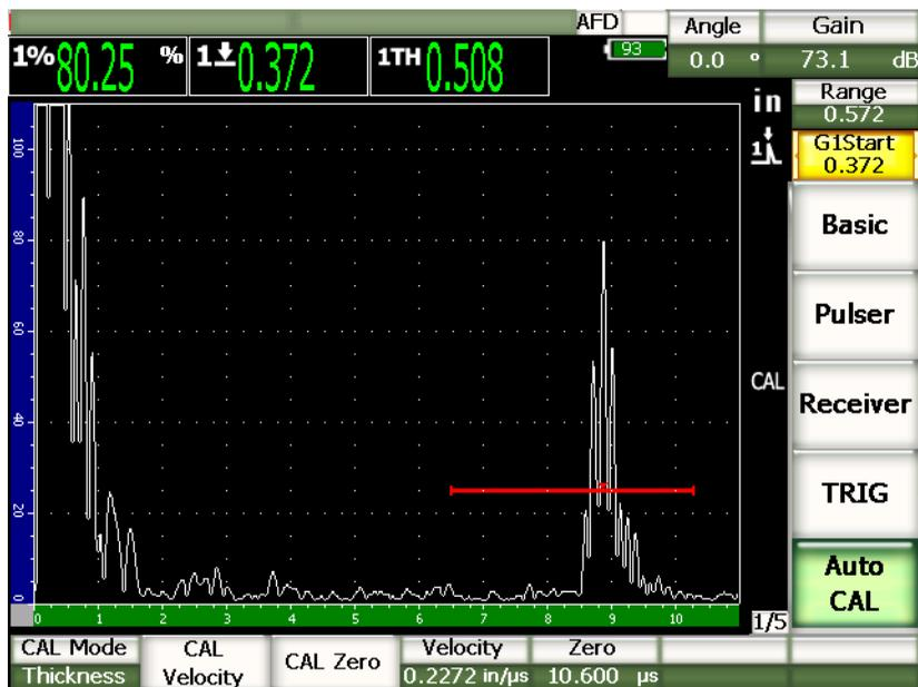
図 9-6 ゲート設定された 2 番目の校正信号
