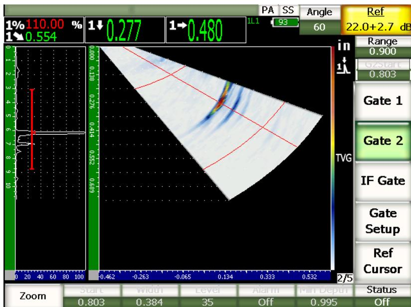
図 15-1 ゲートを表示する A-スキャンと S-スキャン
