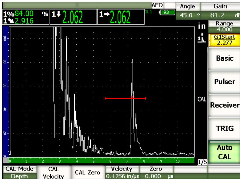
図 9-23 ゲート設定された 2 番目の校正信号
