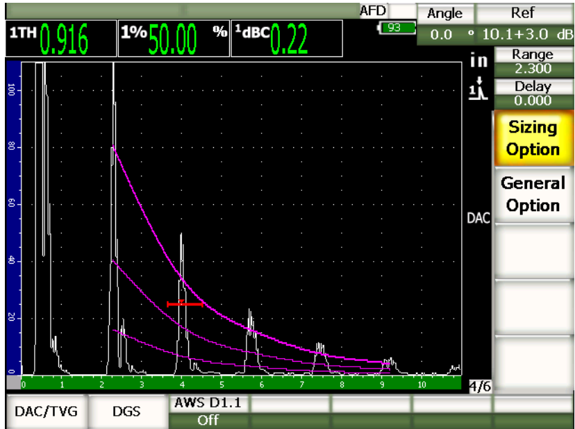
图 11-11 带有 3 dB 扫描增益和激活的参考校正的 ASME DAC 图示
