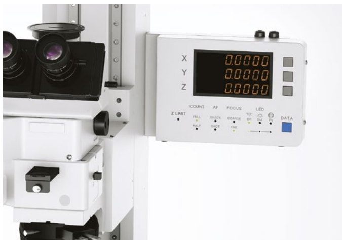
安装在镜架上的数显表
