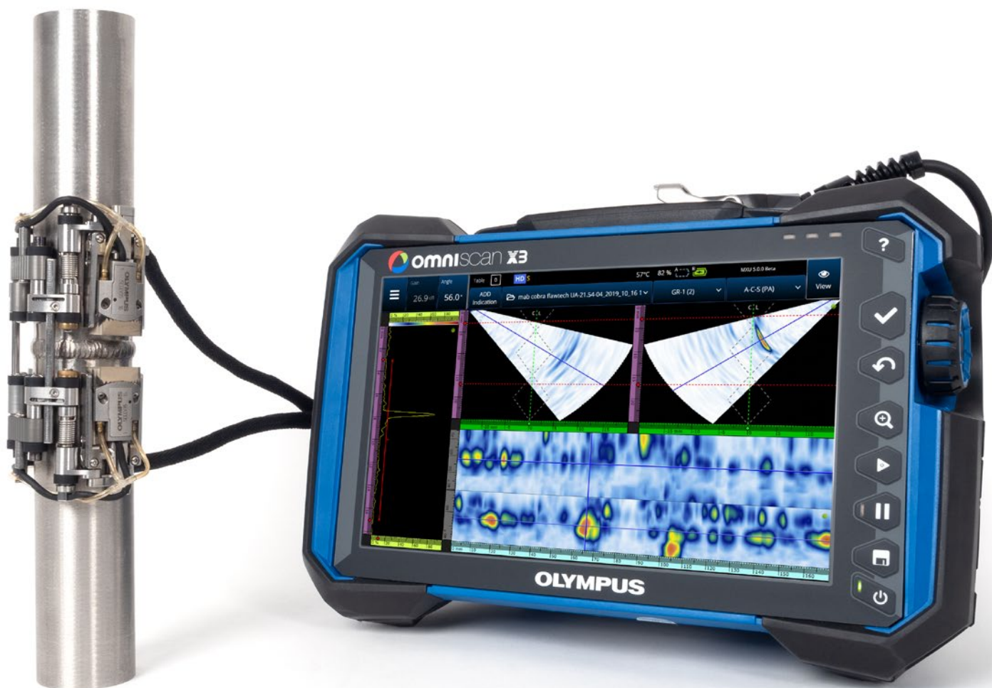
Scanner COBRA avec deux sondes multiéléments A15 sur un tuyau à diamètre externe de 0,84 po, et appareil de recherche de défauts OmniScan X3 affichant deux groupes multiéléments dans des vues sectorielles et C-scan
