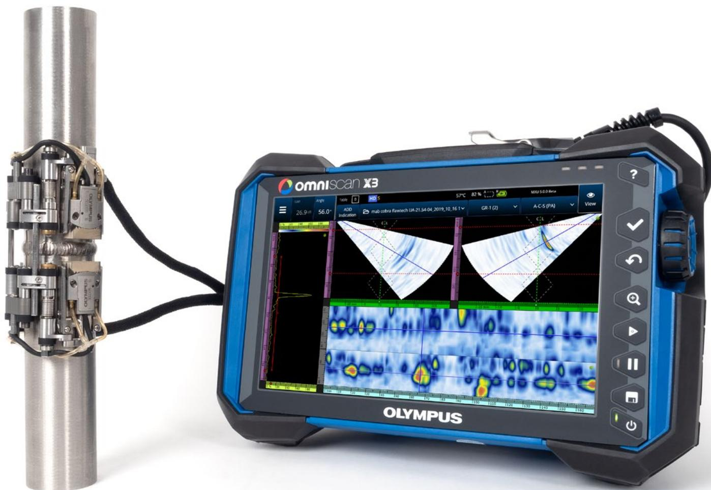
Lo scanner COBRA su una tubazione da 213 mm (0,84 in.) con due sonde A15 PA e un rilevatore di difetti OmniScan X3 con la visualizzazione di due gruppi phased array nelle viste settoriali e C-scan.
