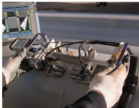
Lo scanner AxSEAM™ può essere usato per l'ispezione di saldature longitudinali di tubazioni in acciaio al carbonio con diametri esterni pari o superiori a 15,24 cm (6 in.).
